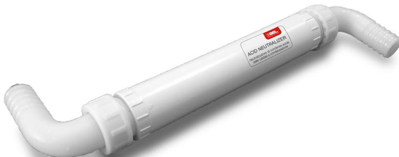
Le caldaie a condensazione producono condense acide (pH compreso tra 3,8 e 5,2) che devono essere neutralizzate prima di essere convogliate allo scarico. La GEL dispone di filtri neutralizzatori che neutralizzano l'acidità dell'acqua di condensa, mantenendo il pH sempre entro i limiti consentiti. Sono disponibili diversi modelli in funzione della potenzialità della caldaia.
